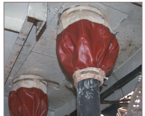
Techeat Expansion® S.21 • Fixation 2 points : passage du four et tube • Etanchéité de type soufflet
